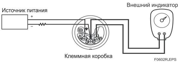
Рисунок 6.3 Подсоединение внешнего индикатора
