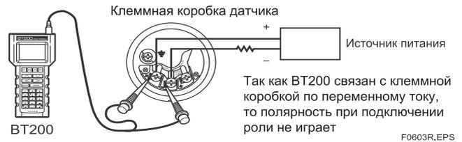
Рисунок 6.4 Подсоединение прибора BT200
