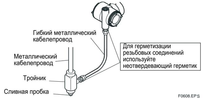
**Рисунок 6.13** Типичный пример проводки с использованием гибкого металлического кабелепровода
