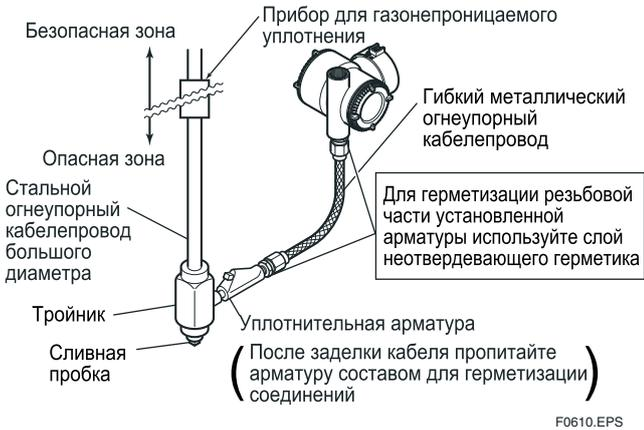
Рисунок 6.15 Прокладка кабеля с использованием металлического огнеупорного кабелепровода
