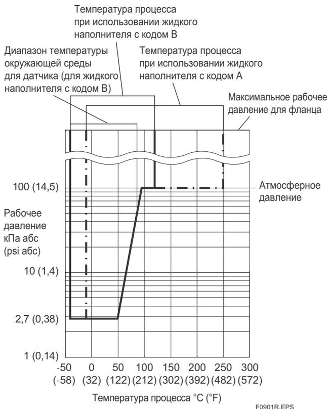
**Рисунок 9.1 Рабочее давление и температура процесса**
